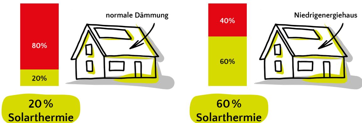
Je nach Größe der Kollektoren und Höhe des Heizenergieverbrauchs kann eine solarthermische Anlage die Heizenergie eines normal gedämmten Hauses im Mittel zu 20 Prozent abdecken. Bei einem Niedrigenergiehaus können es sogar bis zu 60 Prozent sein.
